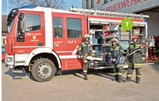
Die Feuerwehr Langenlebarn ist seit Ende 2014 mit einem neuen Hilfeleistungsfahrzeug 2 auf dem neuesten Stand der Technik. Es ist mit Wasserwerfer, hydraulischem Rettungssatz und Seilwinde ausgestattet. Die Stadtgemeinde Tulln unterstützte den Ankauf des insgesamt rund € 375.000,- teuren Fahrzeuges mit € 250.000,-.
